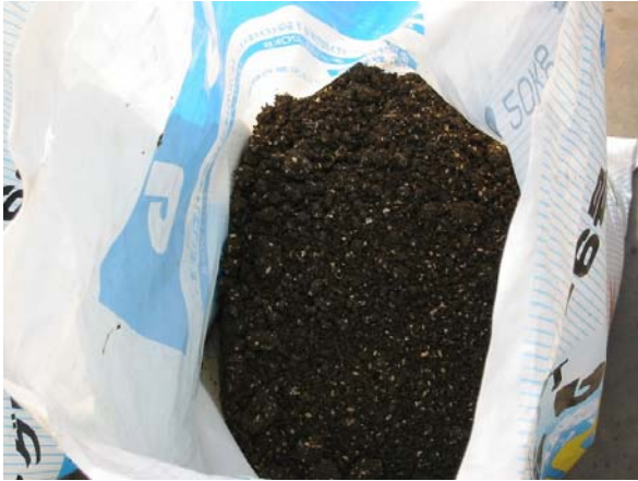
写真1 土壤充填処理工程① (フスマ混合土の充填)
