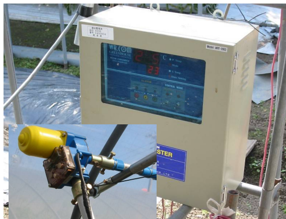
第 1 図 自動遮光区で用いた自動開閉器（ハウスマスター-WRT2002）また、設定温度は第 1 表のとおりとした。
