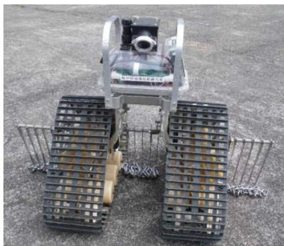
図1 試験に用いた除草ロボット (ロボット中央及び左右にチェーンを装着)
