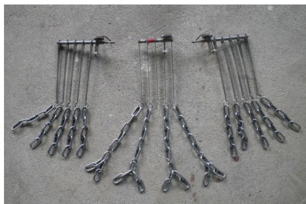
図3-1 中央強化型のチェーンの構成 写真中央が中央チェーン6-2, 2個(先端分岐)
