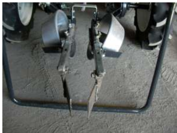
写真1 自作の培土板を装着した移植機
