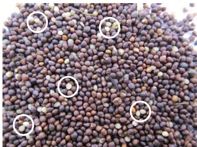
写真7 運転後のエゴマ粒 (2012年、白丸内は種皮が剥離したもの)
