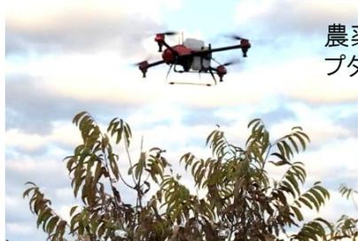
農薬散布用マルチコプター飛行の様子
