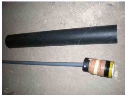
図4 雪密度の測定に用いた円筒
