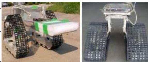
図1 試験に用いたロボット（左：2008年まで使用(クローラ幅9cm)、右：2009年から使用(同幅15cm)）
