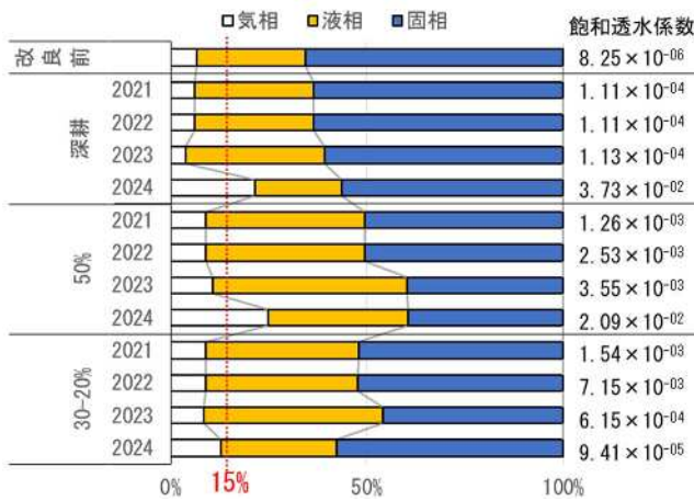
図 6 列状処理による土壌改良がその後の土壌物理性に及ぼす影響（現地：恵那市）
