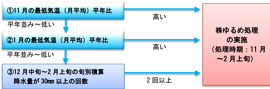
図1 気象条件による危険度判定の手順
