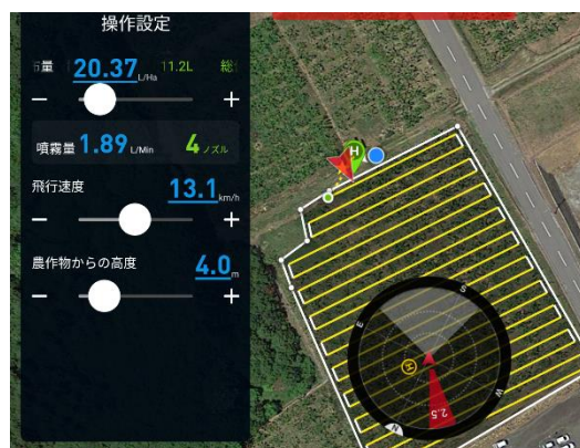
写真2 現地試験における飛行条件設定の様子 左側のパネルにて散布条件、右側の航空写真内で飛行経路(黄色の線)が設定可能である。
