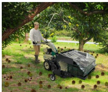
写真3 共同開発された自走式収穫機(左:機体の外観、右:作業イメージ)
